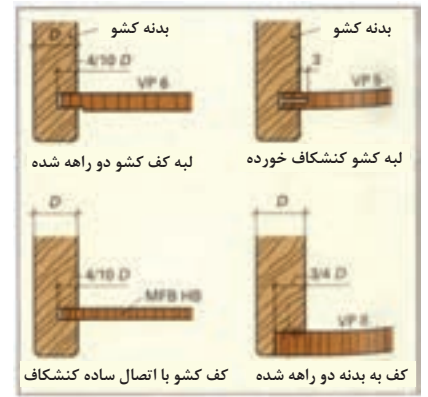
شکل ۱۹- ساخت کف کشو در حالت‌های مختلف
