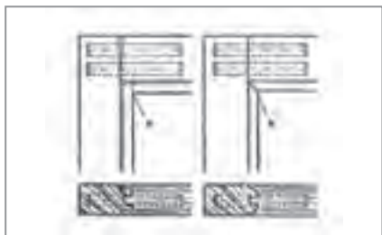
شکل ۲۵- ب) طریقه ترسیم نمای اتصال گوشه‌ای دوبل با پروفیل به صورت فارسی نشده (a) و فارسی شده (b).
