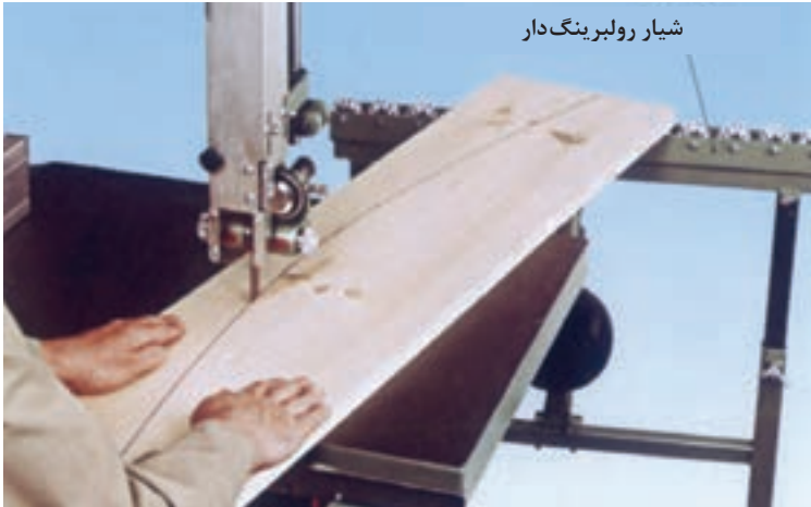
شکل ۱- طرز قرار دادن دست‌ها روی قطعه کار هنگام بریدن
