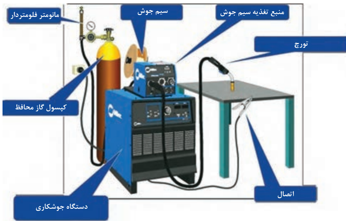
شکل ۶- قسمت های مختلف دستگاه جوشکاری FCAW
