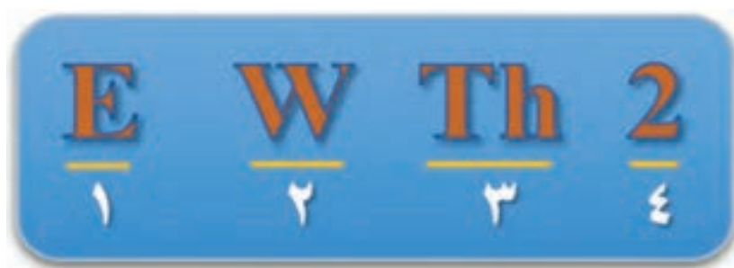
شکل ۱۰- نحوه نام‌گذاری الکترود تنگستن
