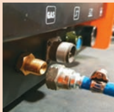
شکل ۶- نصب اتصال گاز محافظ
