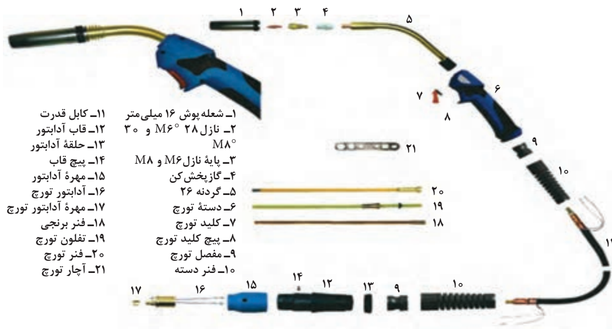
شکل ۷- اجزای تشکیل دهنده تورچ GMAW
