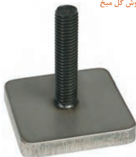
شکل ۲- اتصال ایجاد شده به روش گل میخ
