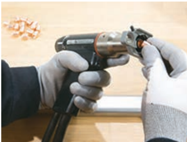
شکل ۲۰- قرار دادن محافظ سرامیکی
