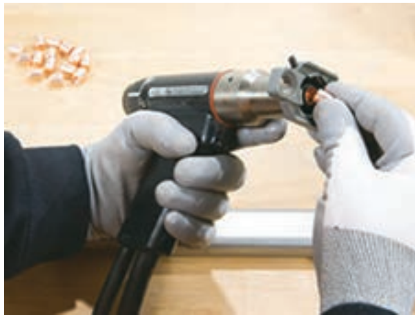
شکل ۱۹- قرار دادن گل میخ در داخل نگهدارنده
