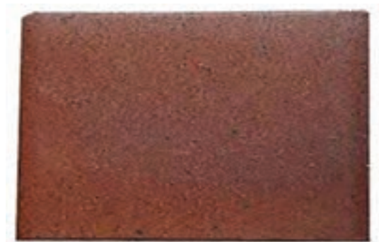
شکل ۸- سینی و آجر نسوز قالب جوشکاری
