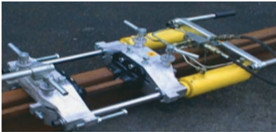
شکل ۱۲- ماشین هیدرولیک برش گرده اضافه جوش
