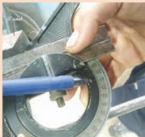
شکل ۲۳- بررسی صحت زاویه با گونیای مرکب
