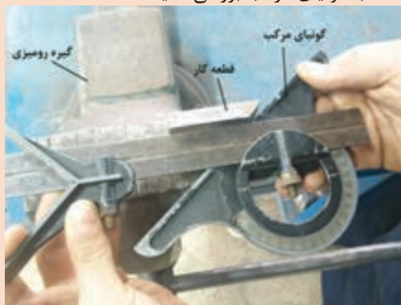
شکل ۲۳- بررسی صحت زاویه با گونیای مرکب
