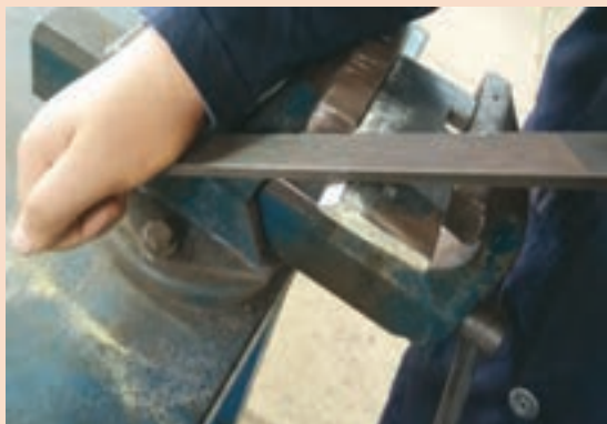
شکل ۱۵- اره کاری و سوهان کاری ورق برای ایجاد پخ ۴۵ درجه
