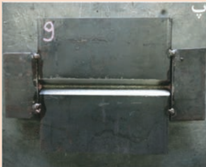
شکل ۲۱- موقعیت دهی و مونتاژ قطعه کار
