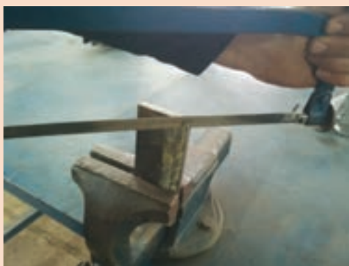
شکل ۱۵- اره کاری و سوهان کاری ورق برای ایجاد پخ ۴۵ درجه
