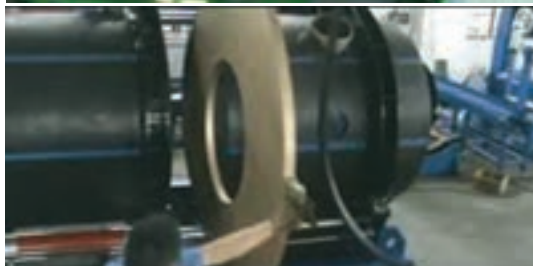
شکل ۱۹- جوشکاری لب به لب Butt Fusion
