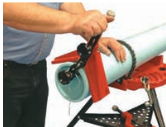
شکل ۲۵- پخ زدن قطعات پلاستیکی برای جوشکاری
