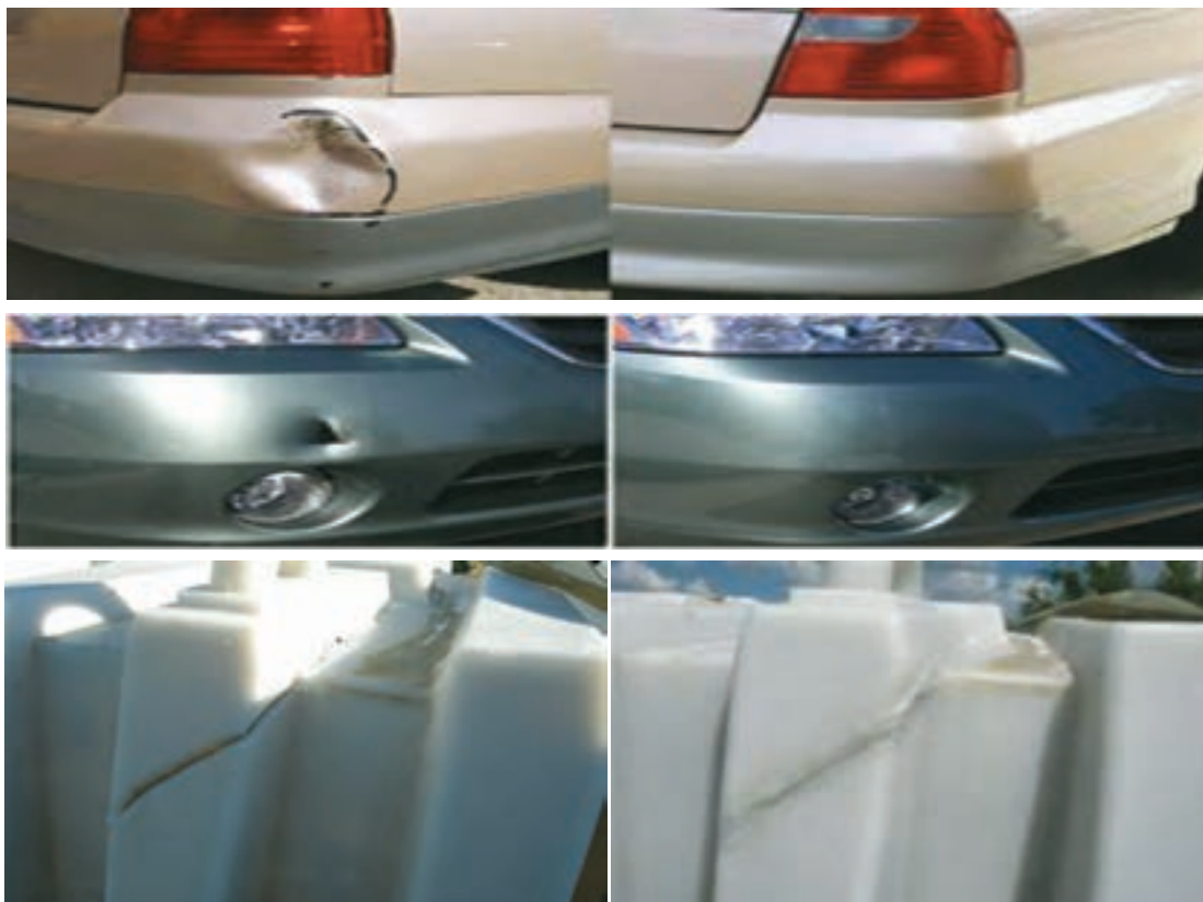
شکل ۲۴- نمونه‌هایی از جوش تعمیری قبل و بعد از جوشکاری
