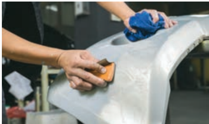
شکل ۳۱- پولیش قطعه کار پس از تعمیر
