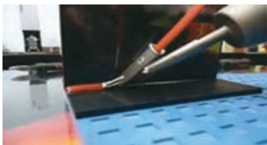
شکل ۱۰- جوشکاری با گاز داغ و مفتول جوش پلاستیک
