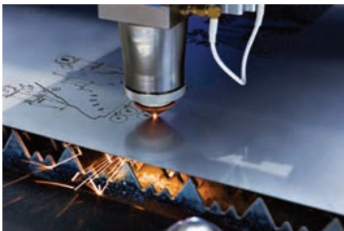
شکل ۱۹: برشکاری با پرتو لیزر
