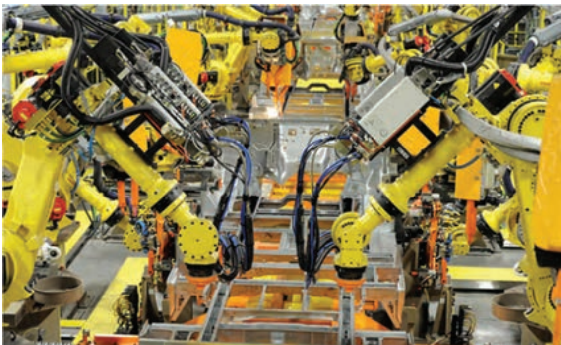
شکل ۳۵: خط مونتاژ مجهز به ربات صنعتی
