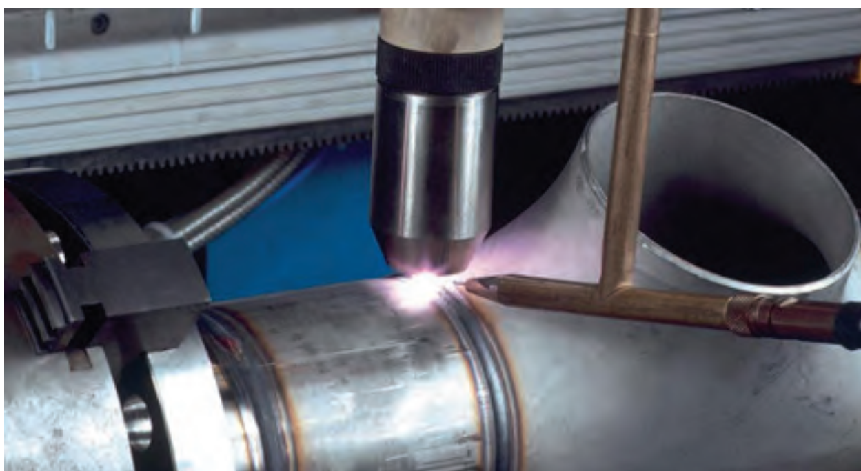
شکل ۲۸: جوشکاری قوس پلاسما
