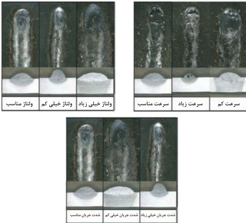
شکل ۱۷- تأثیر سرعت حرکت دست، شدت جریان و ولتاژ بر ظاهر جوش
