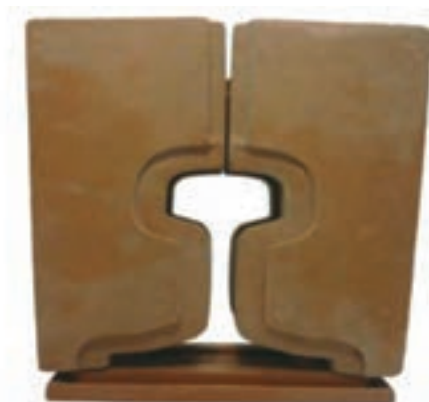
شکل ۷- قالب جوشکاری ترمیت و قرارگیری آن در اطراف ناحیه اتصال
