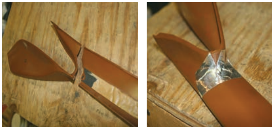
شکل ۲۹- هم‌تراز کردن قطعه به کمک فویل آلومینیومی
