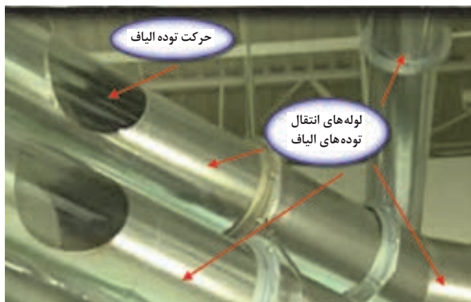
شکل ۸- لوله‌های انتقال الیاف در سیستم شوت فید
