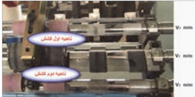
شکل ۲۳- نواحی کشش در رینگ
