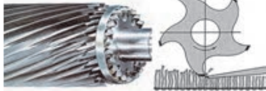
شکل ۱۴- نمایی از سیلندر تیغ و مکانیزم برش در ماشین شیرینگ فرش
