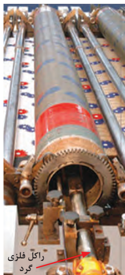
شکل ۲۱- اندرینگ و نحوه قرارگیری آن روی شابلون روتاری و محل قرارگیری راکل و شفت
