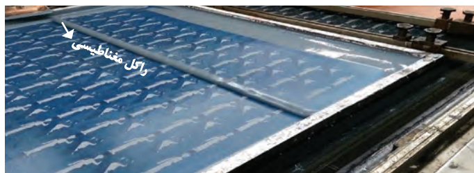
شکل ۱۲- راکل میله‌ای آهن ربایی (مغناطیسی)
