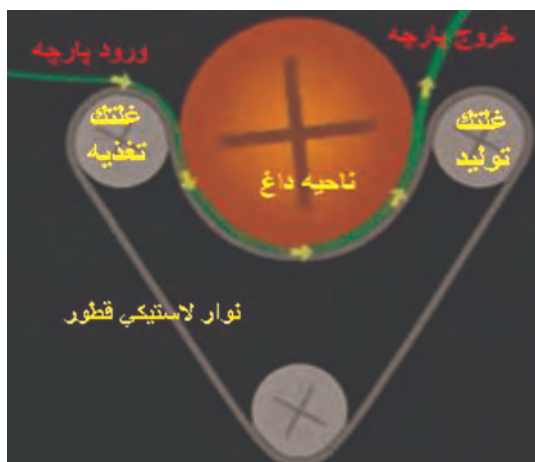
شکل ۴- قسمت تغذیه در ماشین کامپکتور
