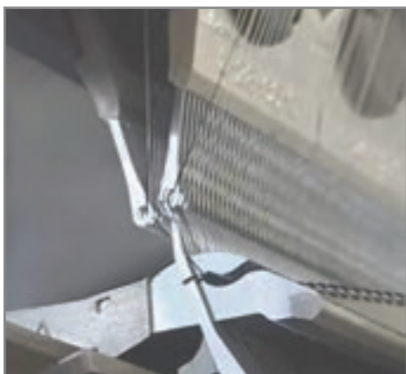
شکل ۳۹- حرکت سوزن از بین شانه‌ها
