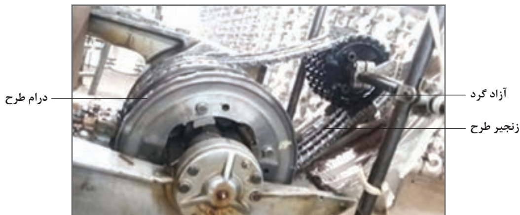
شکل ۴۹- درام طرح و چرخ زنجیر آزادگرد
