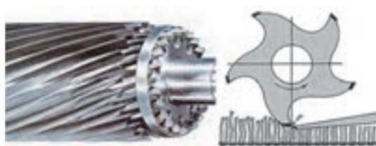
شکل ۱۴- نمایی از سیلندر تیغ و مکانیزم برش در ماشین شیرینگ فرش
