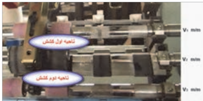
شکل ۲۳- نواحی کشش در رینگ
