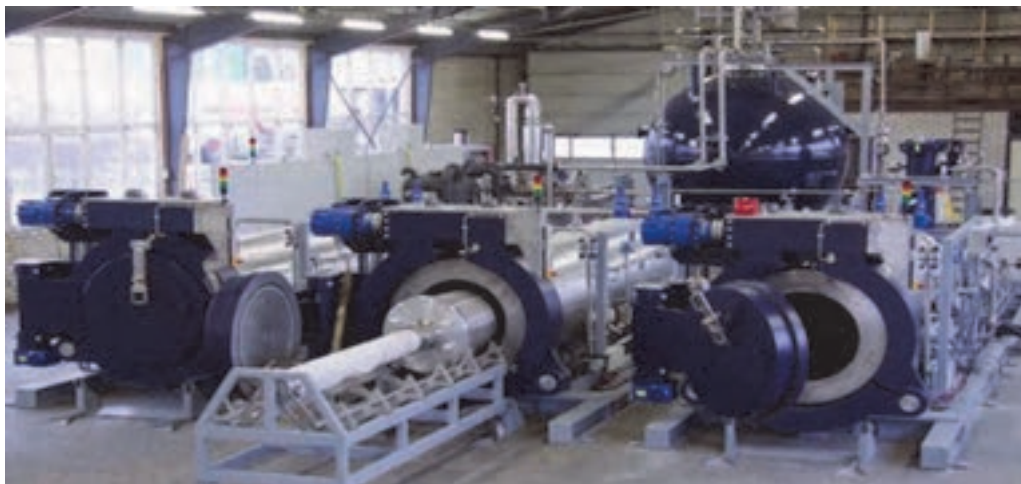
شکل ۲۵- یک نمونه ماشین رنگریزی فوق بحرانی CO ۲
