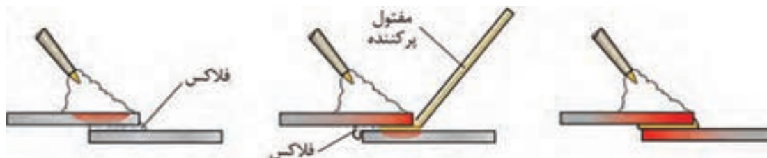
شکل ۲۴- مراحل مختلف جوش با مفتول برنجی
