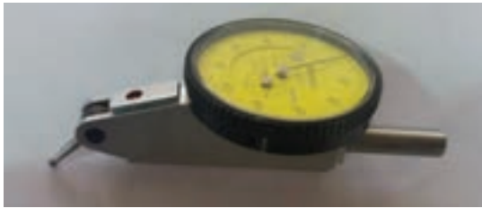
شکل ۲۵- ساعت حساس (شیطانکی) برای کنترل دایره‌ای بودن
