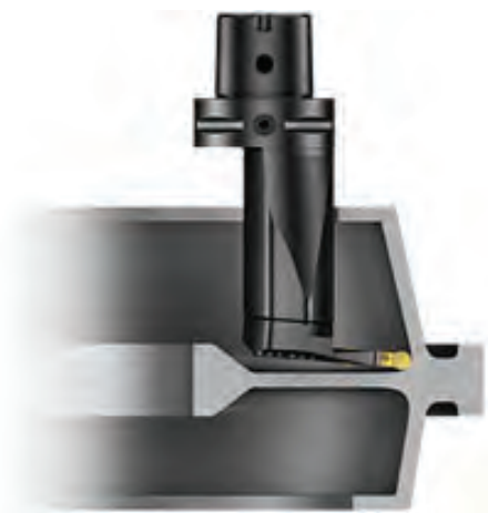
شکل ۶- ایجاد شیار در داخل سوراخ
