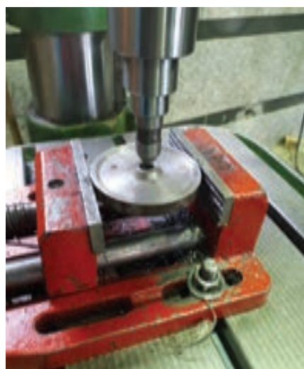
شکل ۱۷- استفاده از مرغک در ایجاد هم مرکزی صحیح
