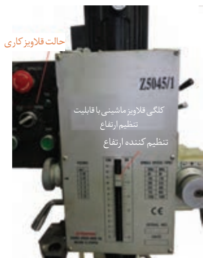
شکل ۴- کُلگی قلاویز ماشینی با قابلیت تنظیم ارتفاع
