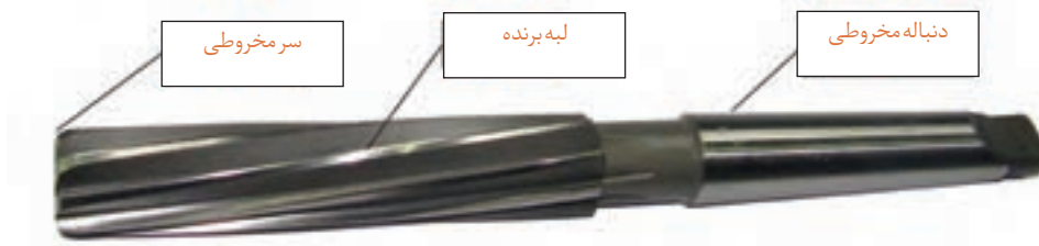
شکل ۹- ساختمان برقوی ماشینی
