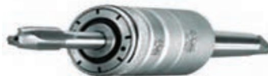
شکل ۵- تجهیزات بستن قلاویز روی ماشین مته ستونی
