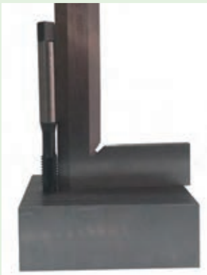
شکل ۷- کنترل عمود بودن قلاویز با سوراخ
