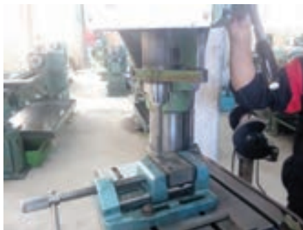
شکل ۱۳- نصب برقوروی محور دستگاه مته
