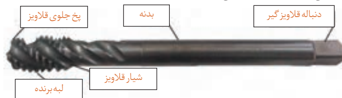
شکل ۲- ساختمان قلاویز ماشینی
