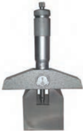
شکل ۵- اندازه‌گیری با میکرومتر عمق سنج
