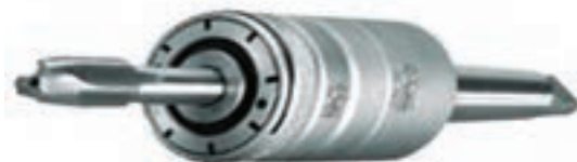
شکل ۵- تجهیزات بستن قلاویز روی ماشین مته ستونی
