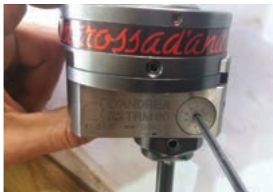
شکل ۲۰-جابه‌جایی به کمک ورنیه‌های روی ابزار
