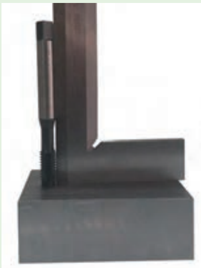
شکل ۷- کنترل عمود بودن قلاویز با سوراخ
