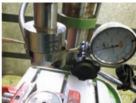
شکل ۱۹-تنظیم مته لنگ بدون میکرومتر و با ساعت اندازه‌گیری
