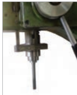
شکل ۱۳- نصب برقوروی محور دستگاه مته
