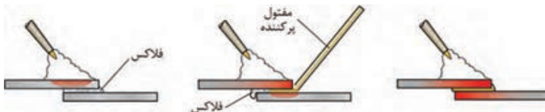
شکل ۲۴- مراحل مختلف جوش با مفتول برنجی
