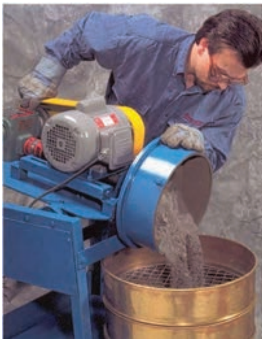
شکل ۵- آسیای آزمایشگاهی مورد استفاده در تعیین شاخص توان آسیای نیمه خودشکن
