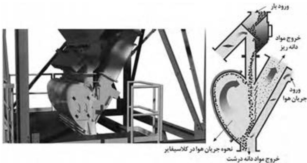
شکل ۱۵- کلاسیفایر اینرسی ثقلی
