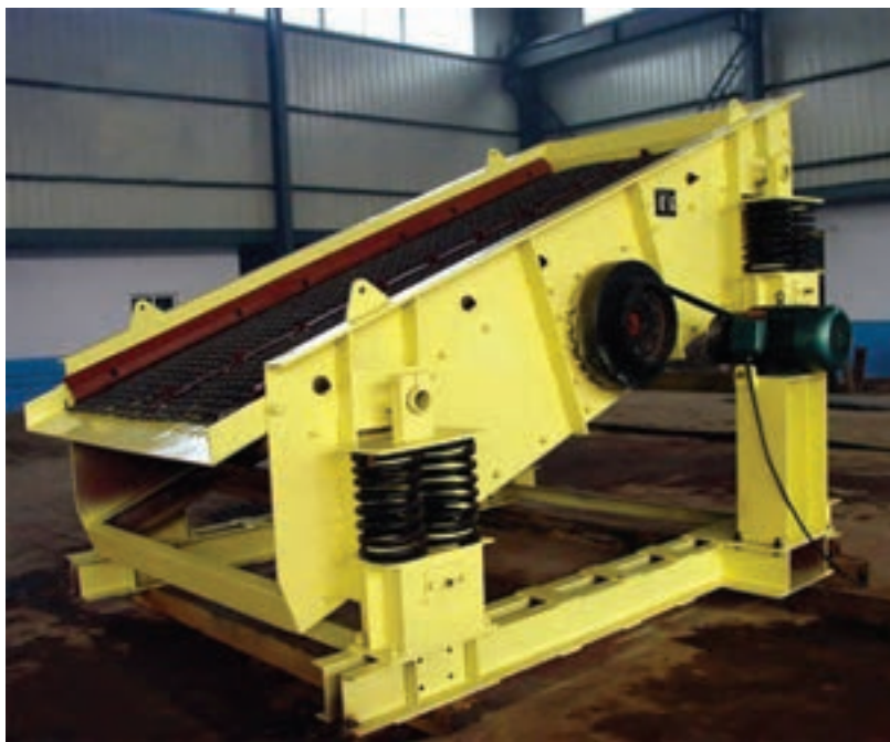
شکل ۵- سرندهای با حرکت نوسانی
