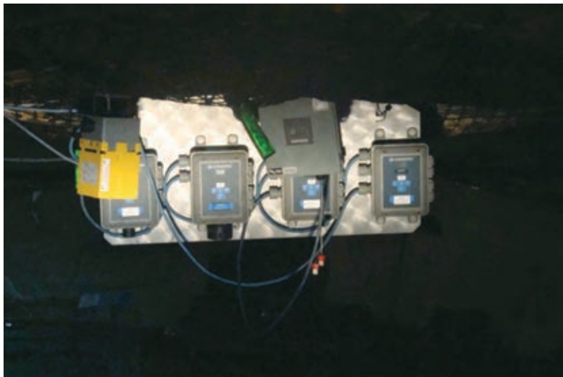
گازسنج‌های دائمی در سینه کار معدن
