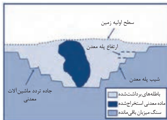
یک معدن در حال استخراج به روش پله ای و شکل شماتیک مقطع عرضی آن
