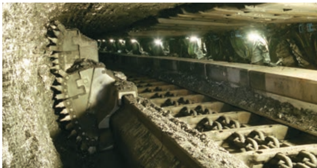
ماشین رنده، ناو زنجیری، جک‌های هیدرولیکی متحرک در استخراج به روش جبهه کار طولانی مکانیزه
