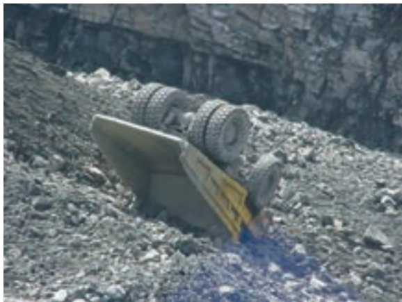
سقوط یک دامپتراک به دلیل عدم وجود دیواره اطمینان (Berm)
