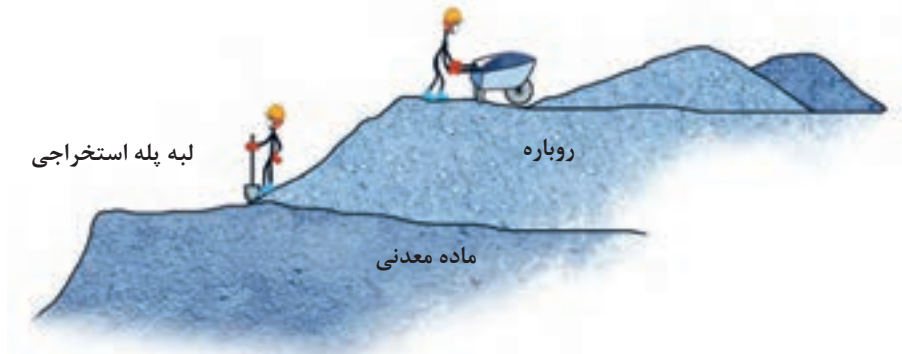
نحوه برداشت روباره در معادن روباز
