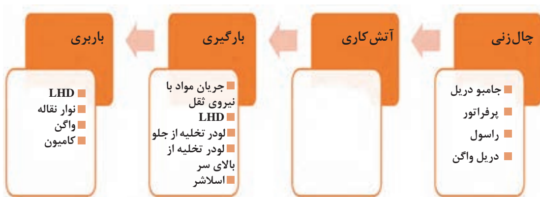
مدل شماتیک استخراج در معدن کایرونا و تأثیرات زیست محیطی آن
