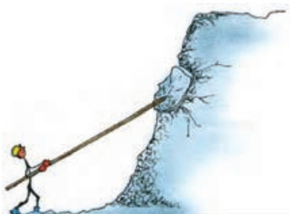
لق‌گیری با چوب بلند و از پایین
