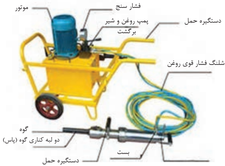
برش سنگ با استفاده از دستگاه پاس و گوه هیدرولیک (داردا)
