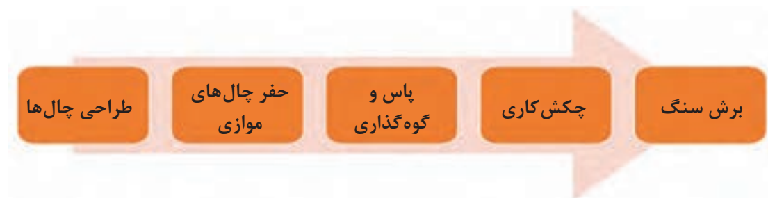
بلوک استخراج شده با روش چال موازی مراحل استخراج با روش چال‌های موازی
