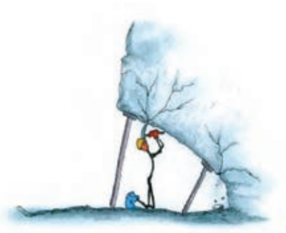
ایجاد زیر برش با نصب وسیله نگهدارنده
