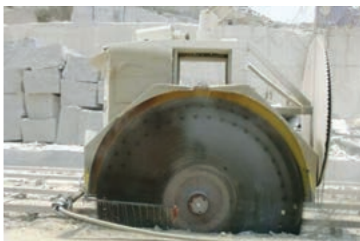
دستگاه دیسک برنده در حال برش سنگ
