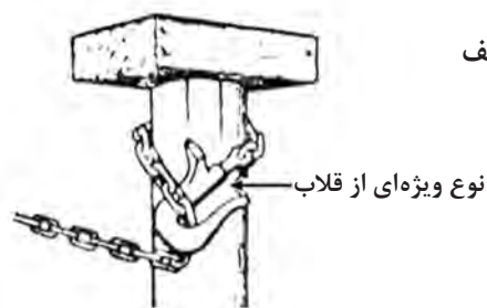
الف) نحوه بستن قلاب به دور پایه
