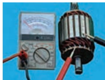
– آزمایش اتصال بدنه آرمیچر
