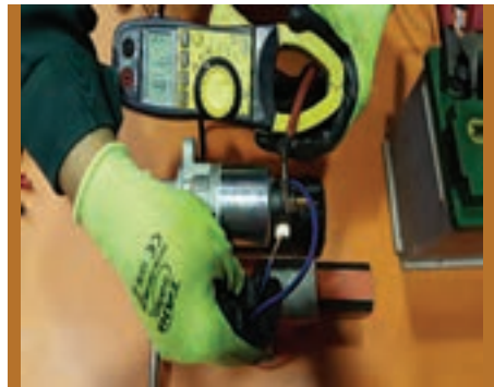
۳- پس از بستن آمپرمتر، ترمینال B اتوماتیک استارتر را به ترمینال S اتوماتیک وصل کنید تا موتور استارتر شروع به چرخش کند.
