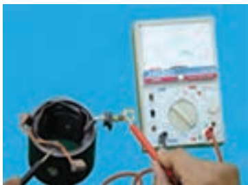
– آزمایش اتصال بدنه بالشتک ها
