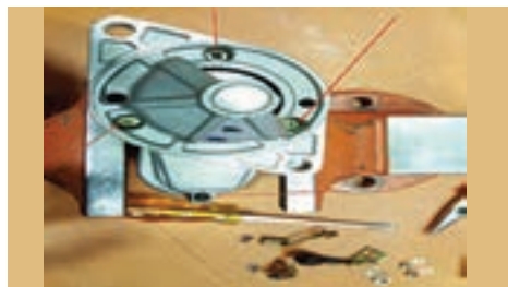
- باز کردن پیچ‌های در پوش جلو
