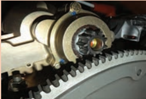
شکل ۱۰۰-ارتباط دنده فلاپیول با دنده استارت
