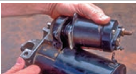
- خارج کردن اتوماتیک استارتر
