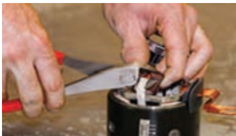
شکل ۹۹ – برخی نکات لحیم کاری زغال‌های استارتر
