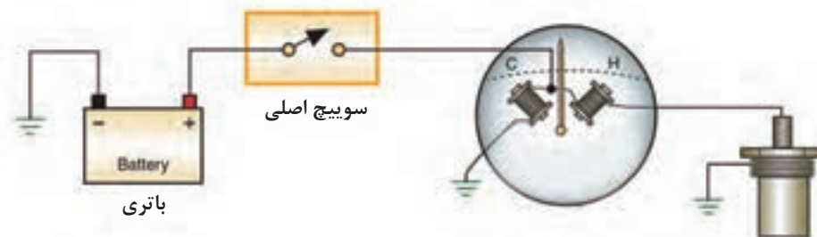
شکل ۱۴- مدار نشان دهنده و حسگر دمای مایع خنک کننده موتور
