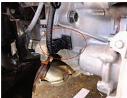
شکل ۱۸- حسگر دور موتور و محل بستن آن
