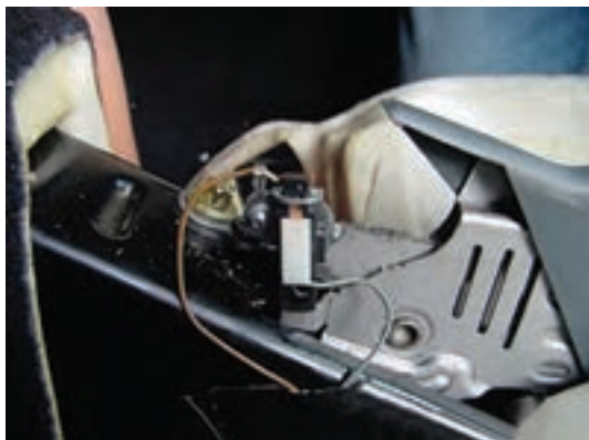
شکل ۲۴- میکروسوییچ ترمز دستی و محل بستن آن
