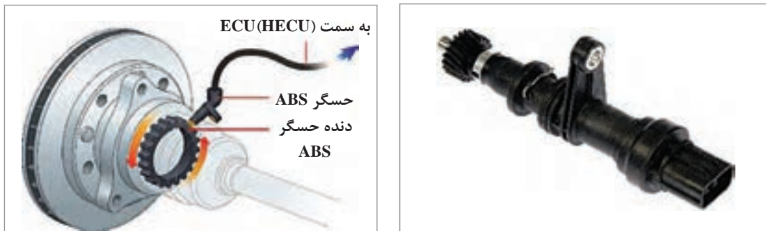
شکل ۱۶- حسگر سرعت خودرو از نوع القایی
