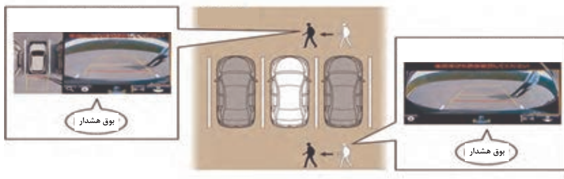
شکل ۱۳- سیستم‌های کمکی وجود عابر پیاده را در مسیر حرکت خودرو به راننده اطلاع می‌دهند.
