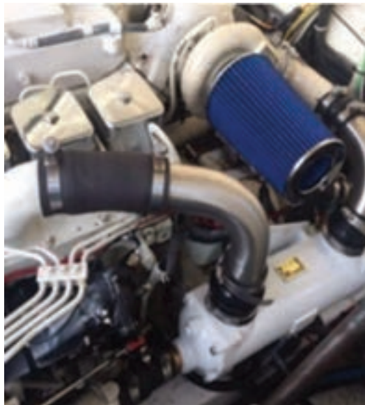
شکل ۸۹- افتر کولرهای استفاده شده در خودرو
