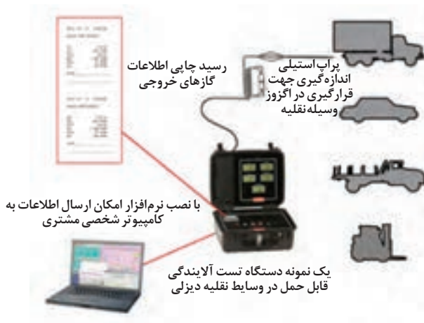
شکل ۷۹- یک نمونه دستگاه تست آلاینده‌ها در وسایط نقلیه دیزلی
