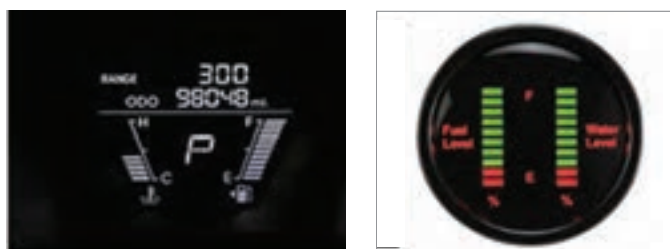
شکل ۱۸- نمایشگر سوخت دیجیتالی (میله‌ای)
