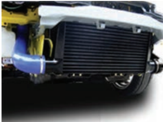
شکل ۸۸- اینتر کولرهای استفاده شده در خودرو
