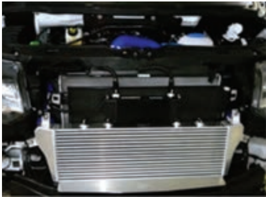
شکل ۸۸- اینتر کولرهای استفاده شده در خودرو
