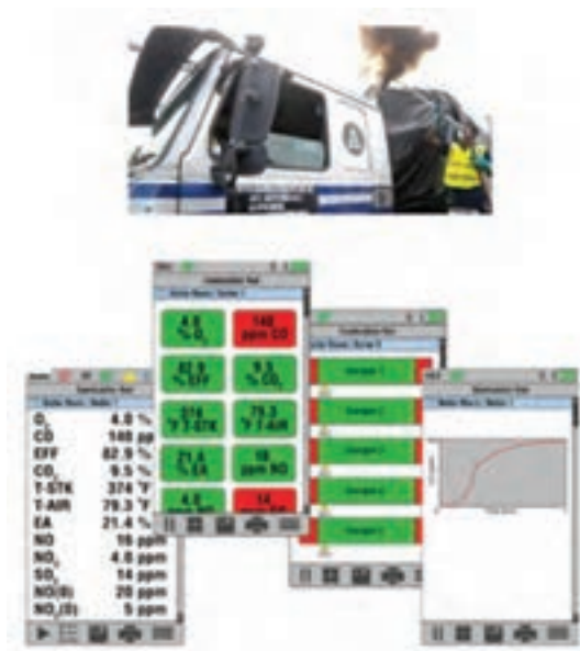
شکل ۷۹- یک نمونه دستگاه تست آلاینده‌ها در وسایط نقلیه دیزلی
