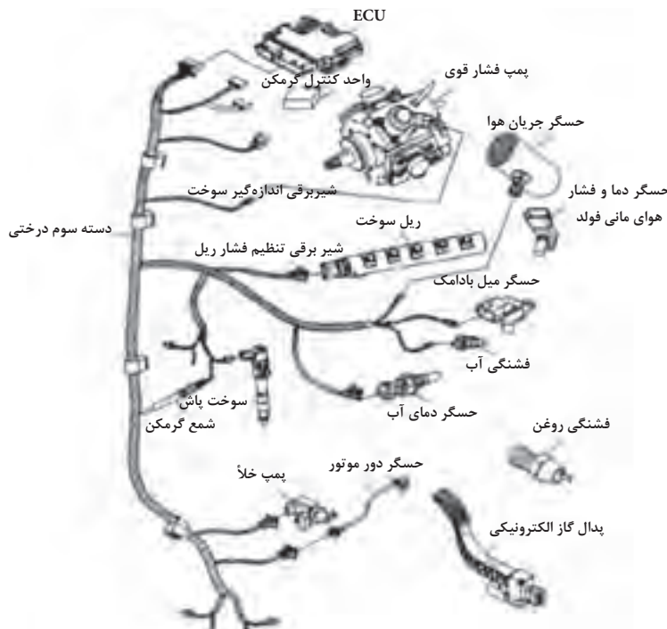
شکل ۷۴-نقشه درختی دسته سیم در یک نوع سیستم سوخت‌رسانی ریل مشترک
