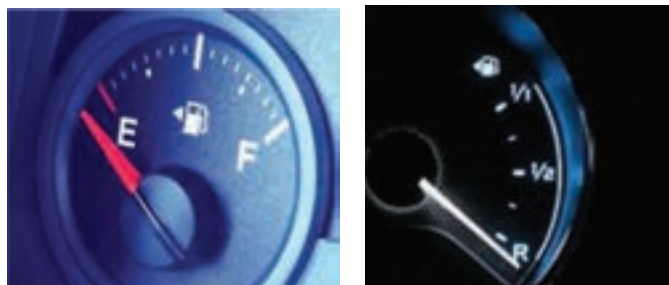
شکل ۱۷- نمایشگر سوخت آنالوگ (عقربه‌ای)
