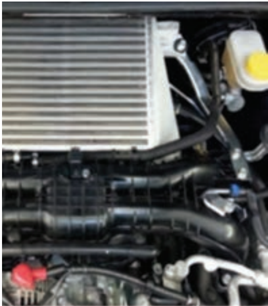
شکل ۸۹- افتر کولرهای استفاده شده در خودرو
