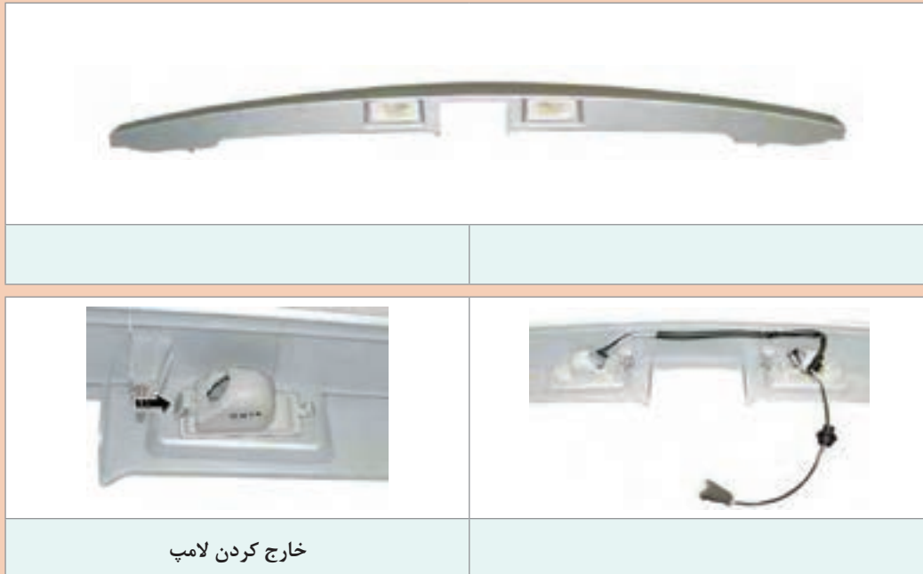
شکل ۳۵- روش باز کردن و بستن چراغ پلاک
