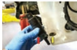
شکل ۳۰- مراحل تعویض پمپ شیشه شوی
