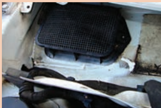
شکل ۲۰- اثر گرفتگی مجرا و عدم تخلیه آب
