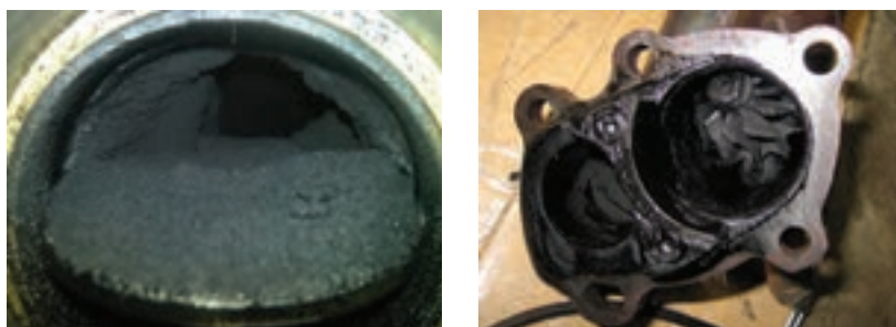
شکل ۸۴- رسوب کربن در ورودی و خروجی توربوشارژر
