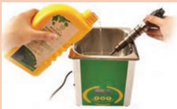
شکل ۷۸- تمیز کردن سوراخ انژکتور با دستگاه اولتراسونیک
