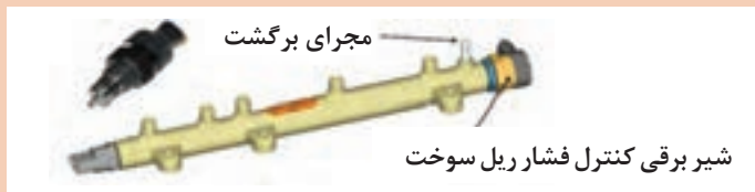
شکل ۳۷- سوپاپ کنترل فشار الکتریکی در تزریق ریل مشترک
