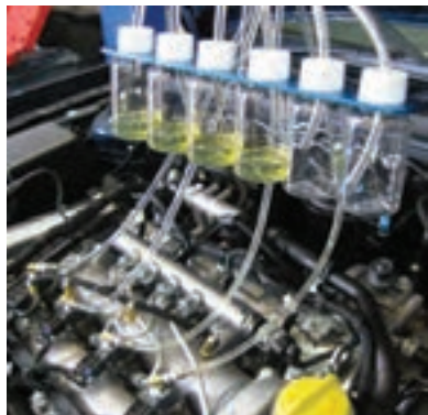
شکل ۵۵- تست اندازه‌گیری مقدار سوخت برگشتی انژکتورها
