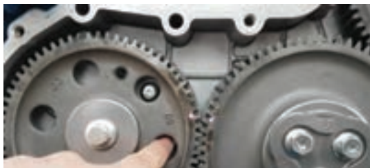
شکل ۵۷- بررسی تایم پاشش سوخت از نحوه اتصال پمپ به موتور
