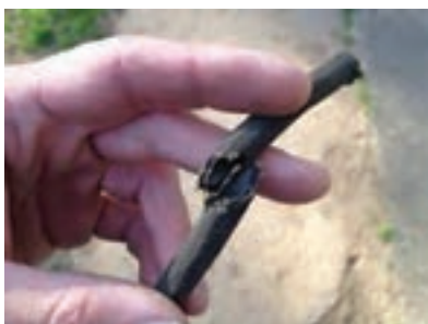
شکل ۴۹- یک نوع نشتی سیستم سوخت‌رسانی
