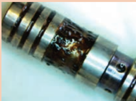
شکل ۷۶- خرابی انژکتور در اثر آب در سوخت
