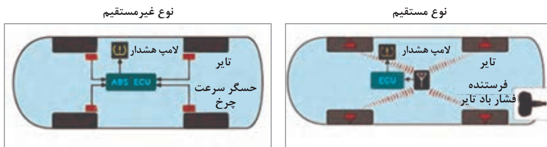
شکل ۲۹- تشخیص فشار مطلق هوا و استفاده از فرستنده شکل ۳۰- تشخیص فشار هوا از ظاهری و قطر مؤثر تایر برای ارسال اطلاعات
