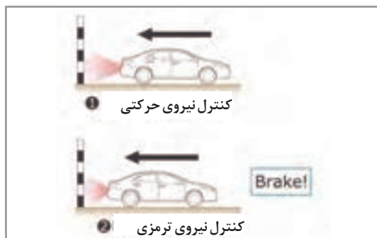
شکل ۴- عملکرد ترمز اتوماتیک با کمک حسگر دنده عقب
