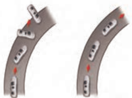
شکل ۱۹- عملکرد سیستم ترمز ضدقفل و سیستم ترمز معمولی در مسیر جاده لغزنده در پیچ
