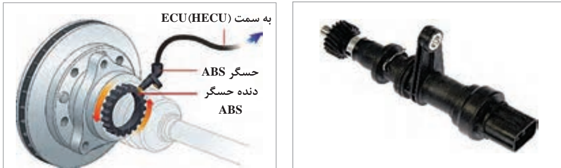
شکل ۱۶- حسگر سرعت خودرو از نوع القایی
