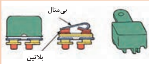
شکل ۱۴- نمونه‌ای از دستگاه کنترل جریان الکتریکی مدار
