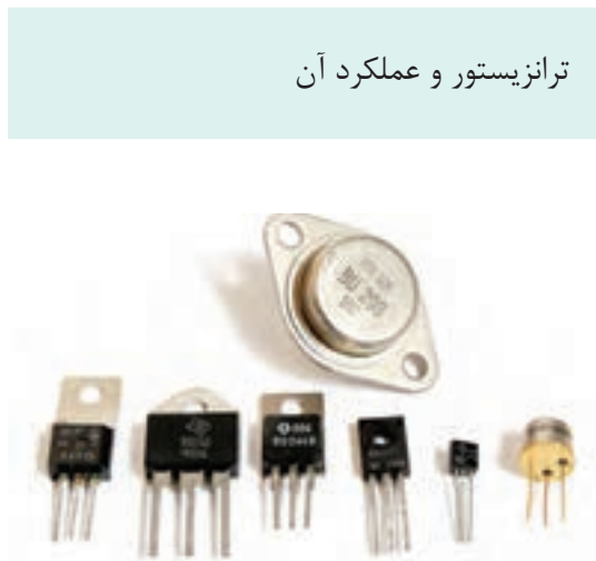
شکل ۲۲- انواع ترانزیستور و عملکرد آن
