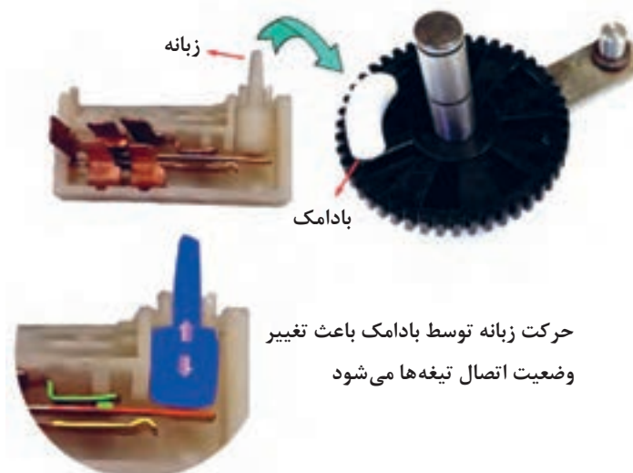
شکل ۸- کلید پارک از نوع پلاتین و بادامک
