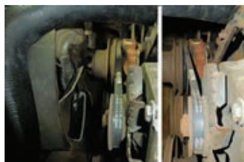
بررسی ناهم‌راستایی تسمه و میزان کشش
