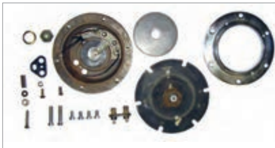
شکل ۴۵- اجزای داخلی بوق الکترومغناطیسی
