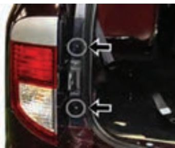
شکل ۳۴- نکات مهم باز کردن، تعمیر و بستن مجموعه چراغ عقب
