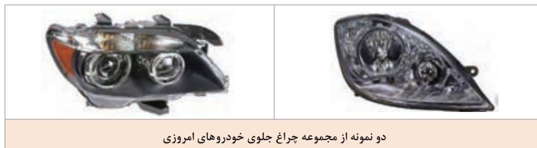
شکل ۱۱- روش بستن و دو نمونه از مجموعه چراغ جلوی خودروی امروزی
