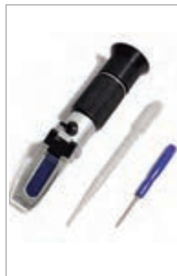
رفلکتومتر، اندازه‌گیری جرم حجمی الکترولیت
