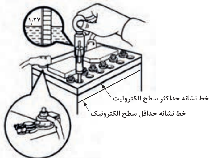
بررسی سطح الکترولیت و کابل‌ها و اتصالات باتری
