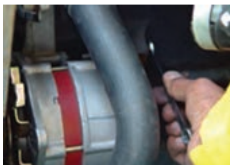
بازکردن پیچ‌های پایه آلترناتور
