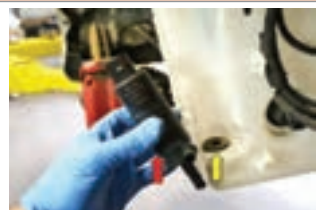
شکل ۳۰- مراحل تعویض پمپ شیشه شوی
