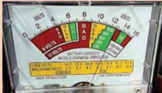
شکل ۵۱- نشان دهنده دستگاه آزمایش باتری
