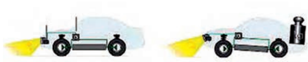
شکل ۹- دلیل نیاز به سیستم تنظیم ارتفاع چراغ
