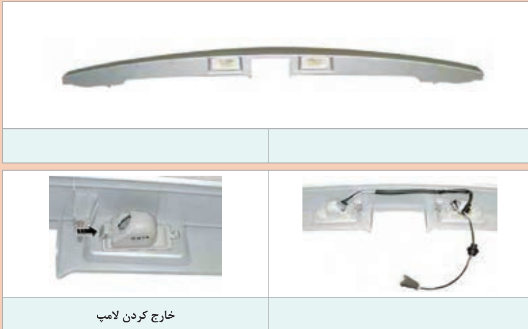
شکل ۳۵- روش باز کردن و بستن چراغ پلاک
