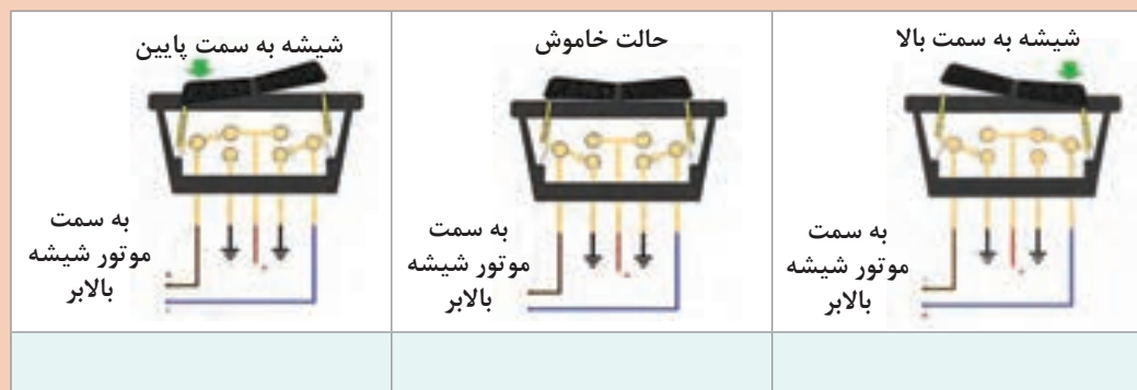
شکل ۶- عملکرد کلید شیشه بالابر الکتریکی
