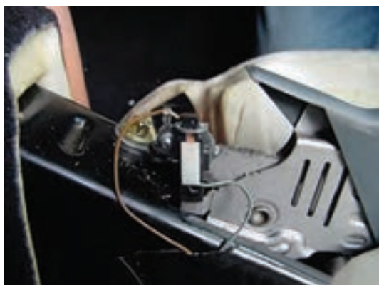
شکل ۲۴- میکروسوییچ ترمز دستی و محل بستن آن
