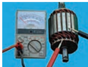
– آزمایش اتصال بدنه آرمیچر
