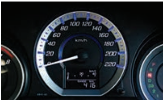
شکل ۲- نشان دهنده از نوع الکترومکانیکی
