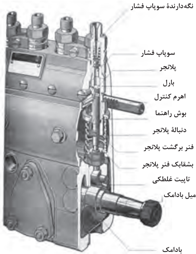
شکل ۳۱- پمپ انژکتور نوع جرک
