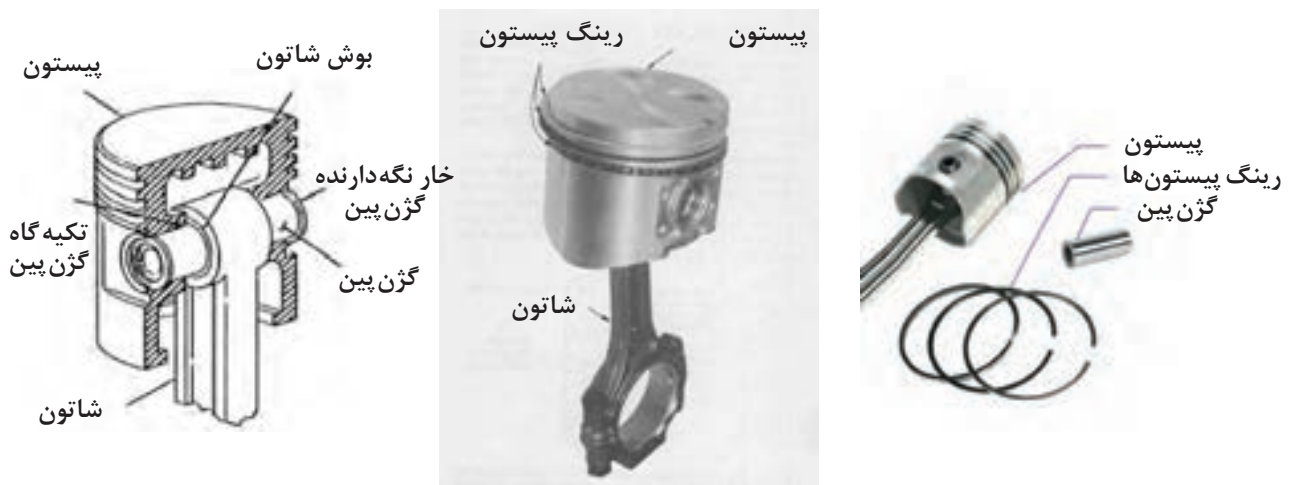
شکل ۲- پیستون و قطعات همراه آن
