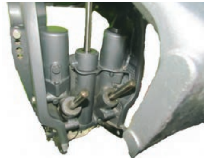
شکل ۳۷- سامانه جک هیدرولیکی
