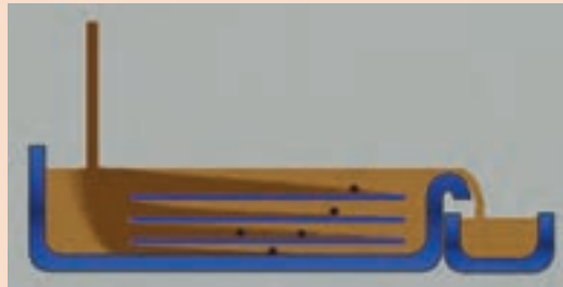
شکل ۲۰- نحوه قرار دادن صفحات موازی درون فیلتر
