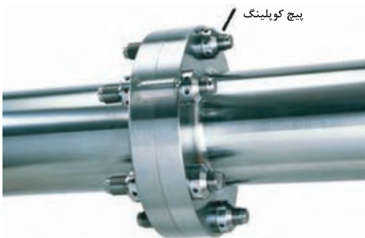
شکل ۲۶- نحوه اتصال محور پروانه توسط کوپلینگ و پیچ
