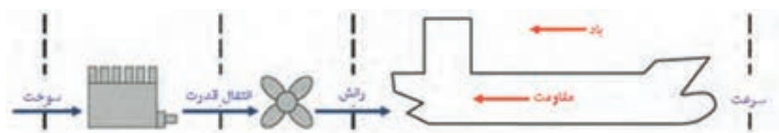
شکل ۱۵- نحوه انتقال قدرت از موتور به شناور جهت رانش شناور
