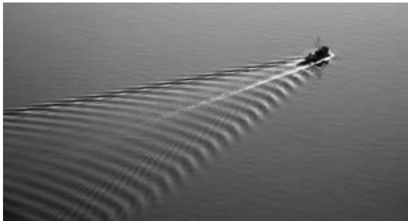
شکل ۴- تشکیل امواج بر اثر حرکت شناور
