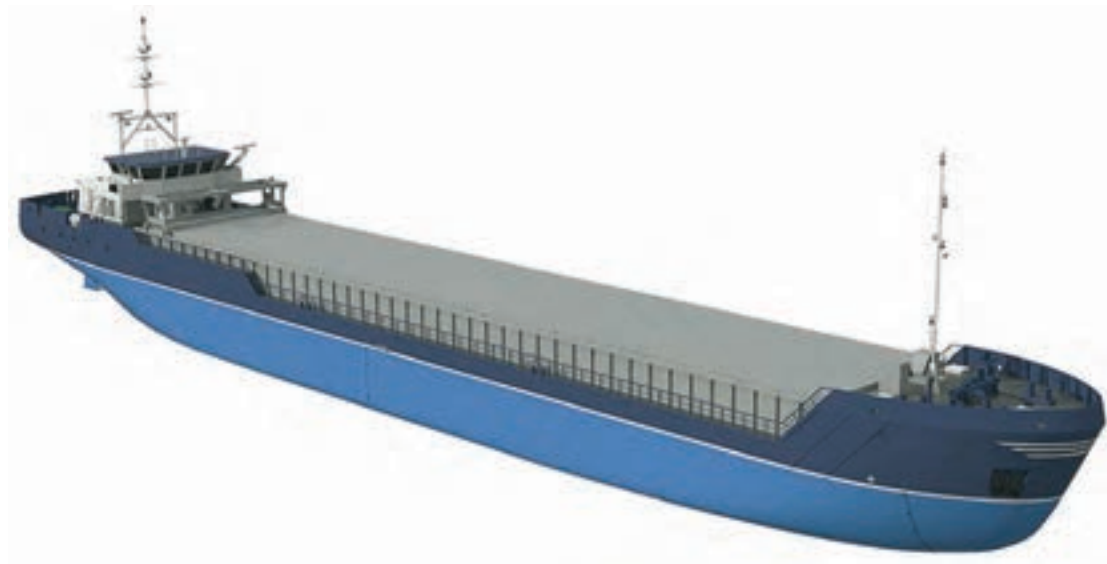
شکل ۱۰- سطح خیس شده شناور (ناحیه آبی‌رنگ)
