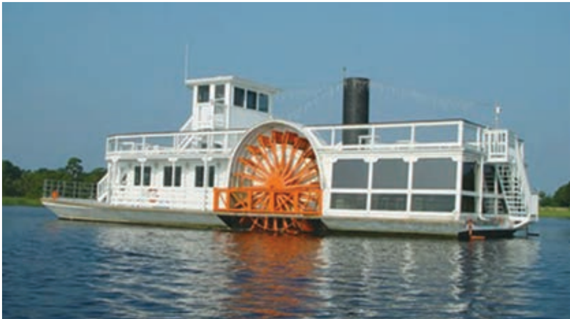
شکل ۱- سامانه پیشران چرخ پدالی
