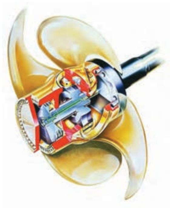
شکل ۷- پروانه گام متغیر
