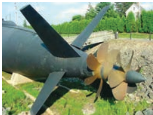
شکل ۸- پروانه های عکس چرخنده
