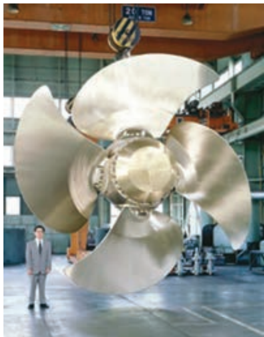
شکل ۷- پروانه گام متغیر
