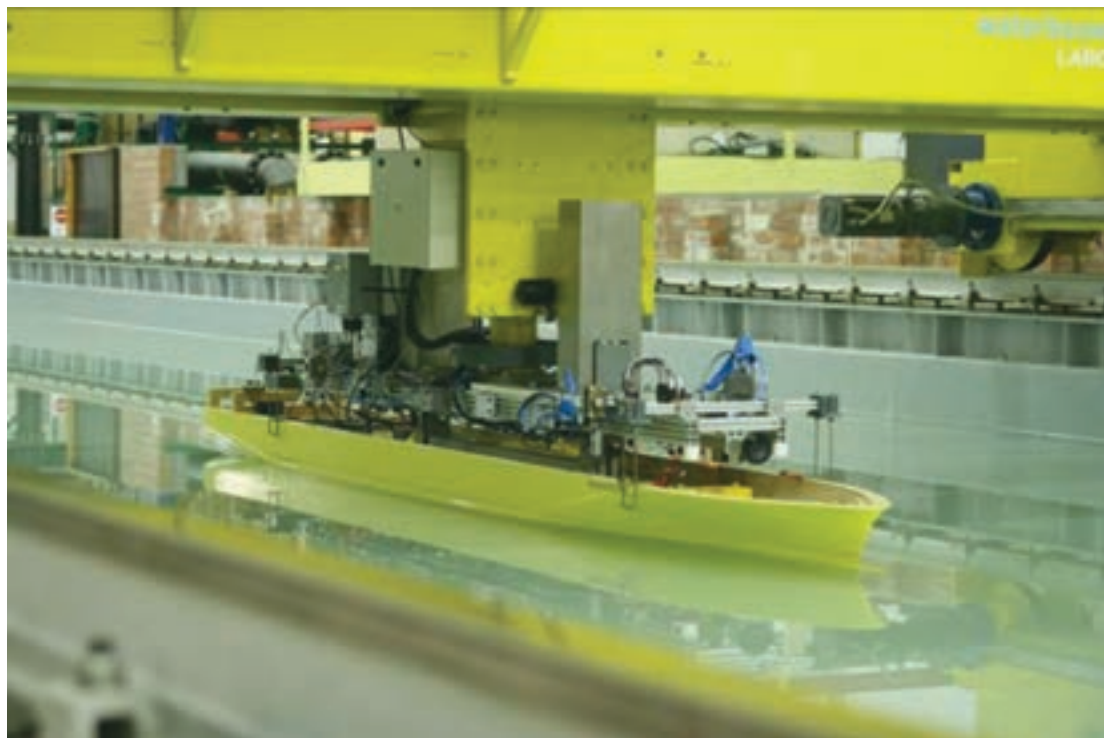
شکل ۱۳- حوضچه کشش و آزمون مدل یک شناور کانینر بر
