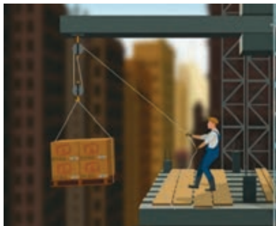
شکل ۲۶- ترکیب دو قرقه برای افزایش بهره مکانیکی
