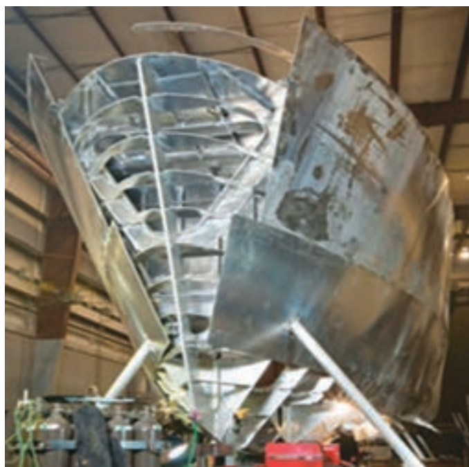
شکل ۲۳- سازهٔ سینهٔ یک شناور در حال ساخت
