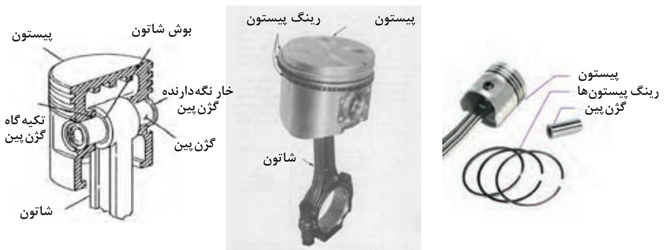
شکل ۲- پیستون و قطعات همراه آن
