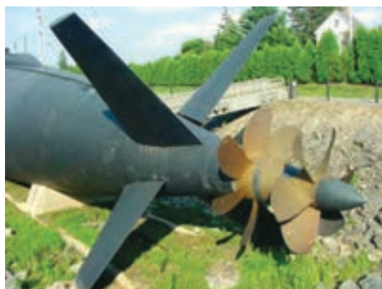
شکل ۸- پروانه های عکس چرخنده
