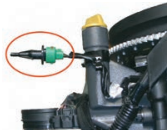
شکل ۱۸- حسگر دمای هوای ورودی
