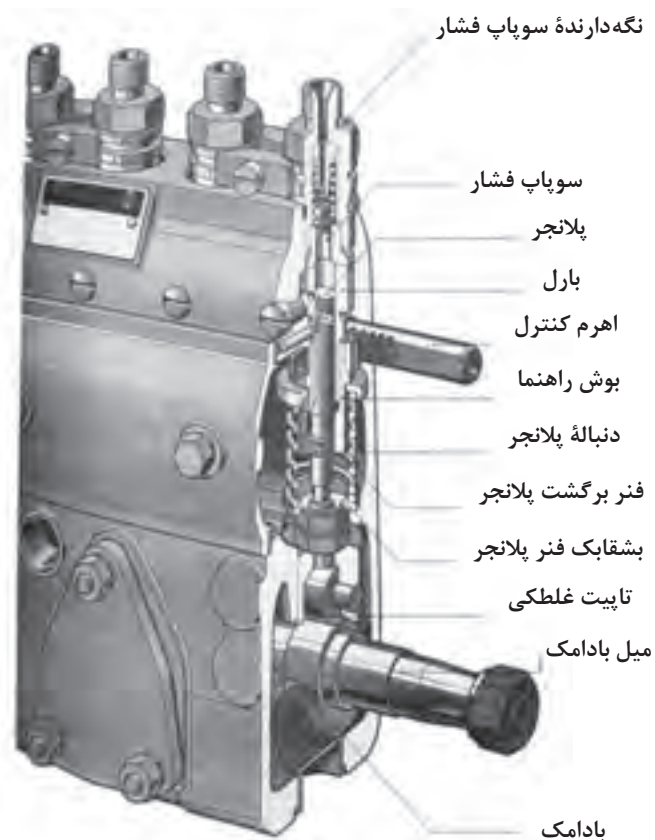
شکل ۳۱- پمپ انژکتور نوع جرک
