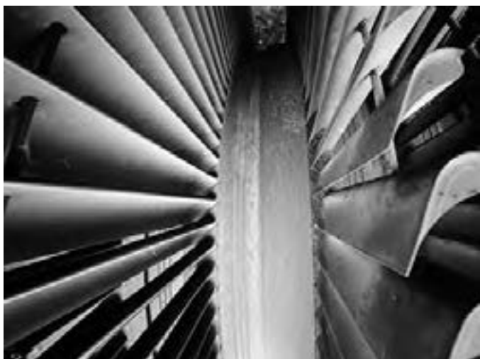
شکل ۸- میله‌های عبور کننده از داخل پره‌ها
