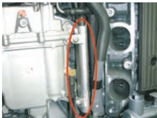
شکل ۱۱- کولر سوخت موتور
