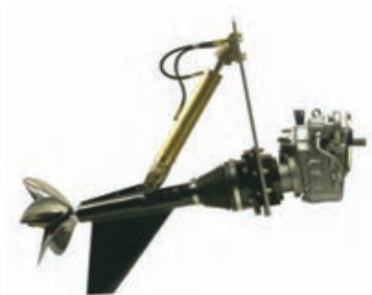
شکل ۱۲- سیستم رانش نیمه مغروق
