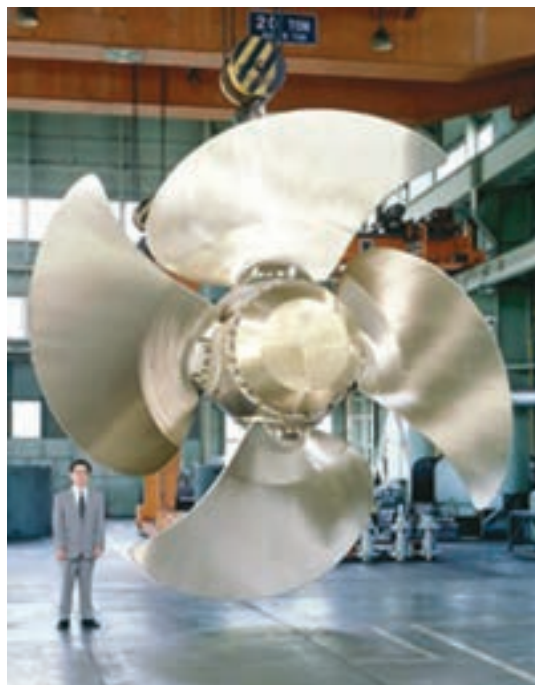
شکل ۷- پروانه گام متغیر
