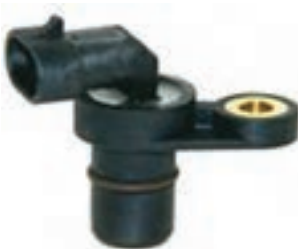
شکل ۱۷- حسگر موقعیت میل بادامک دود
