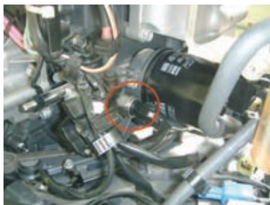
شکل ۲۱- حسگر فشار روغن
