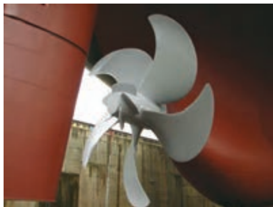
شکل ۱۹- دو نمونه از ساختار متفاوت پاشنه شناور و اتصال پروانه به محور
