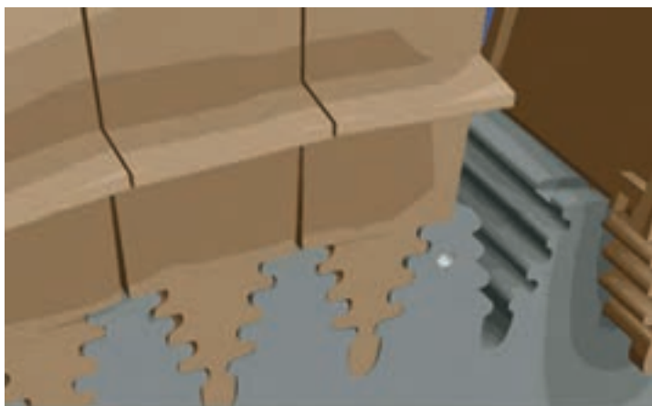
شکل ۶- نمونه ای از یک ریشه از نوع درخت صنوبری معکوس
