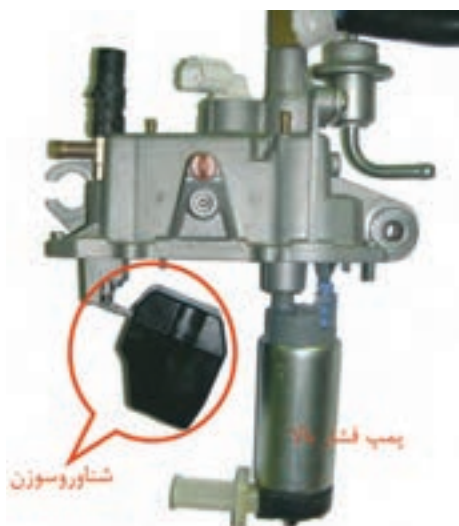
شکل ۸- مجموعه داخل مخزن تفکیک بخار
