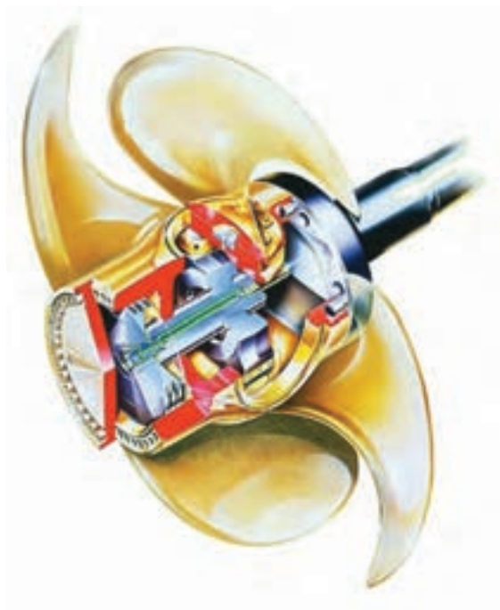
شکل ۷- پروانه گام متغیر
