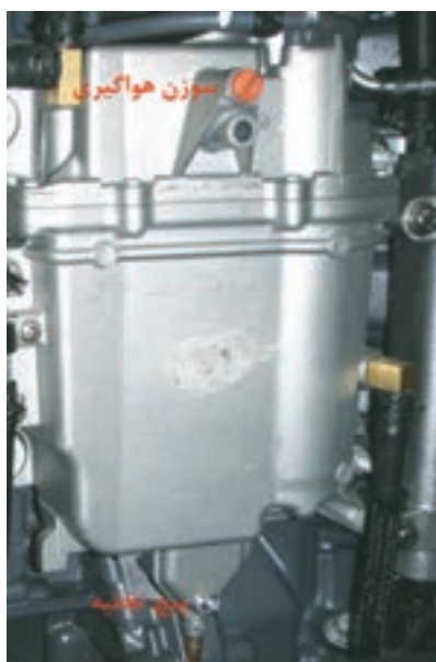
شکل ۷- مخزن تفکیک بخار
