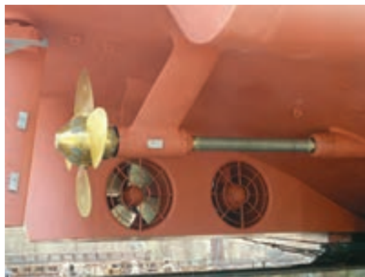
شکل ۱۹- دو نمونه از ساختار متفاوت پاشنه شناور و اتصال پروانه به محور
