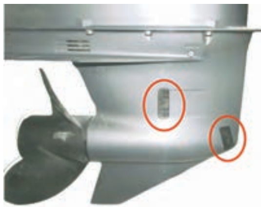
شکل ۳۰- ورودی های آب خنک کننده موتور
