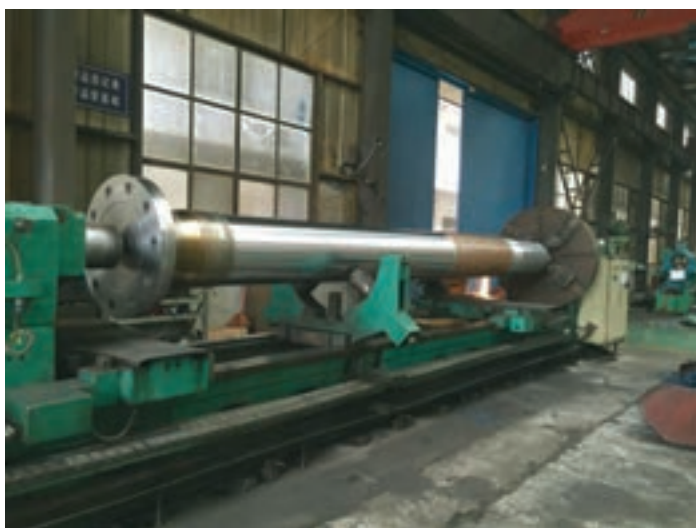
شکل ۹- محور پروانه در کارگاه جهت ماشین‌کاری
