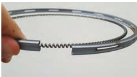
شکل ۱۴- رینگ پیستون
