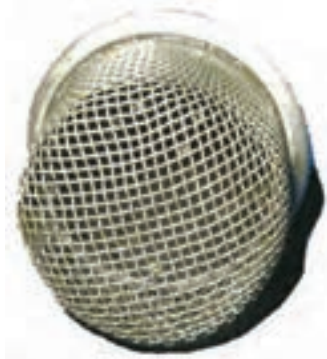
شکل ۲۷- صافی روغن
