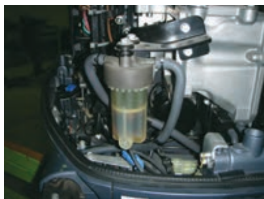
شکل ۴- پالایه اولیه سوخت
