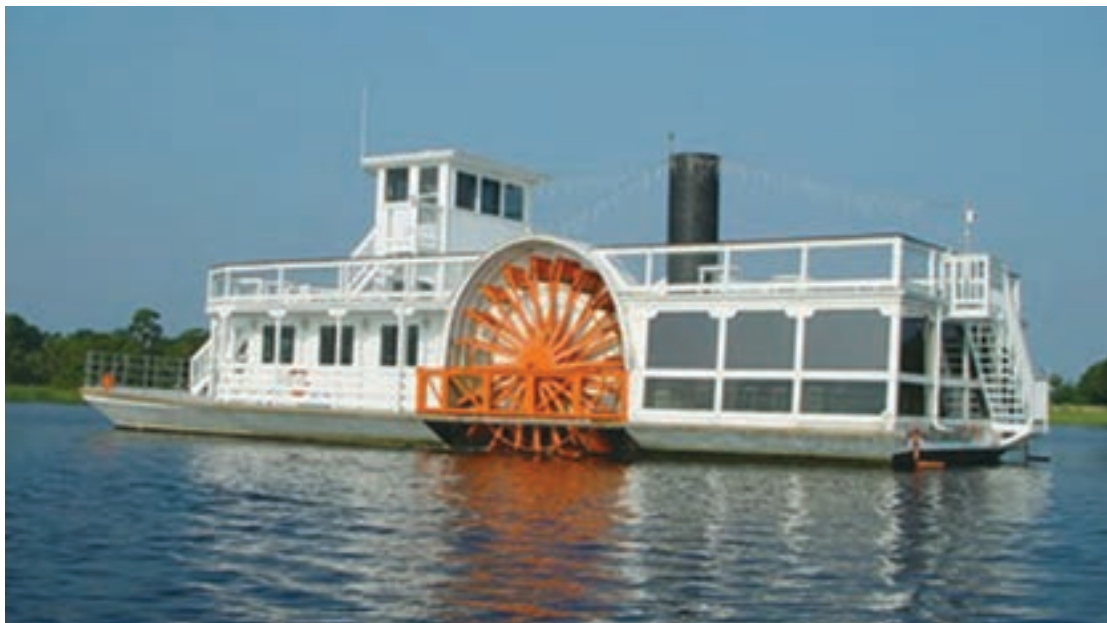
شکل ۱- سامانه پیشران چرخ پدالی
