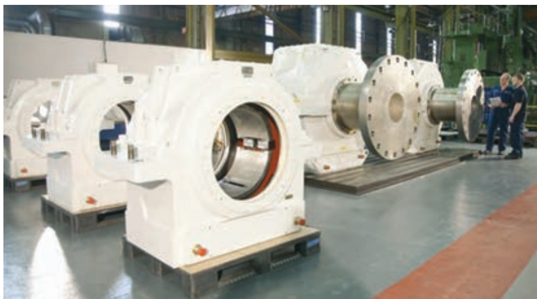
شکل ۲۴- یاتاقان‌های مورد استفاده جهت تکیه‌گاه محور پروانه
