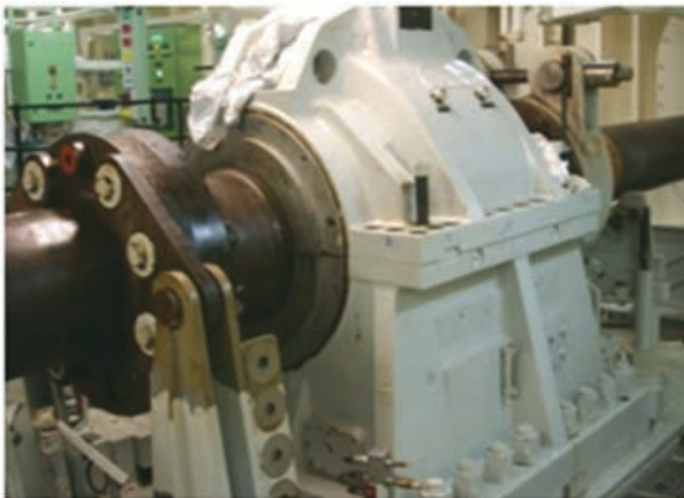
شکل ۲۸- تصویر یک نمونه تکیه گاه رانشی
