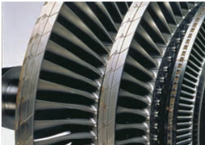
شکل ۷- محل اتصال پره‌ها با چرخ
