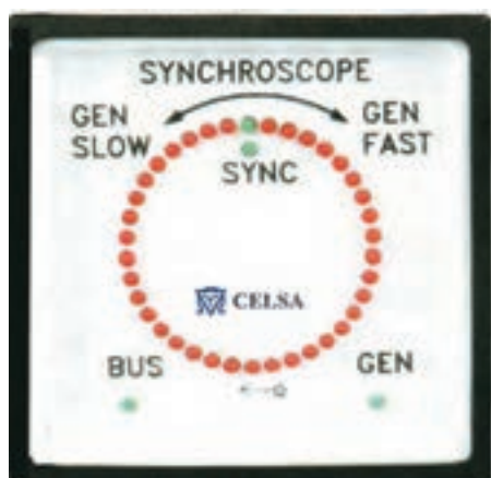
شکل ۲۰- سنکروسکوپ و مدار یک سنکروسکوپ ساده
