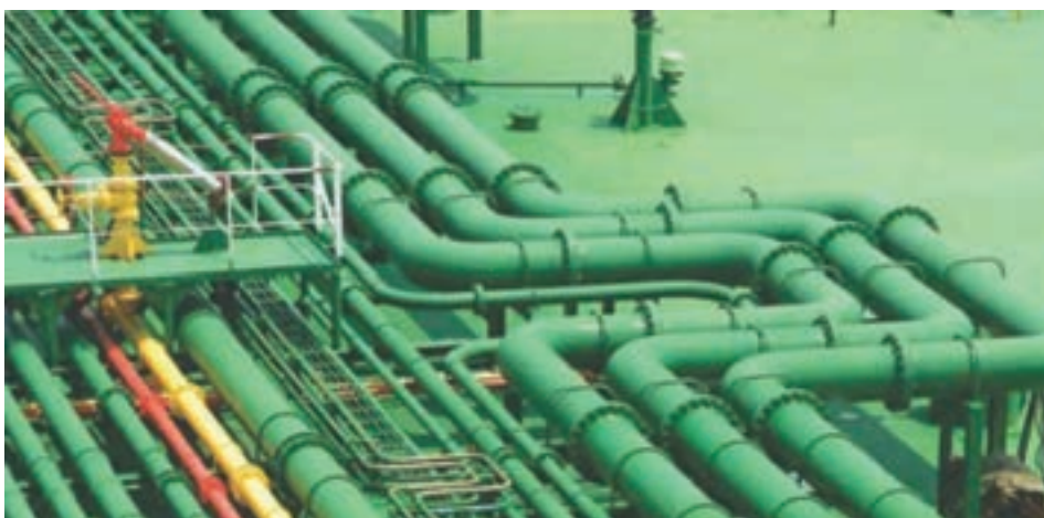
شکل ۲۹- سامانه لوله‌کشی روی عرشه یک نفتکش
