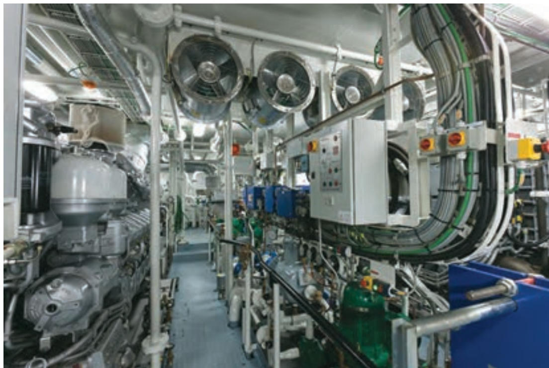
شکل ۱- نمونه‌ای از سامانه تهویه در شناور
