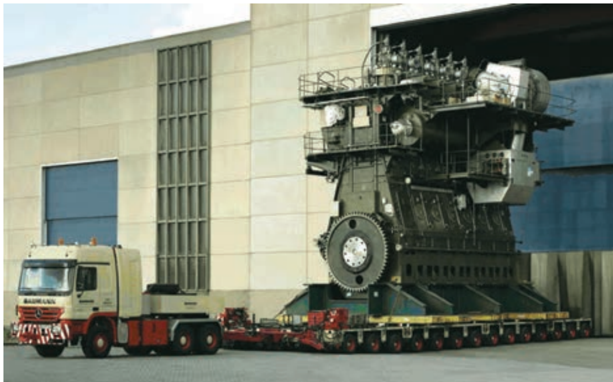
شکل ۴۵ - یک موتور دیزل بزرگ دریایی را نشان می‌دهد که برای نصب بر روی کشتی انتقال داده می‌شود.
