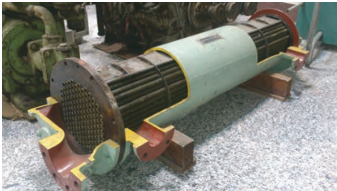
شکل ۴ - نمای برش خورده یک مبدل حرارتی پوسته و لوله
