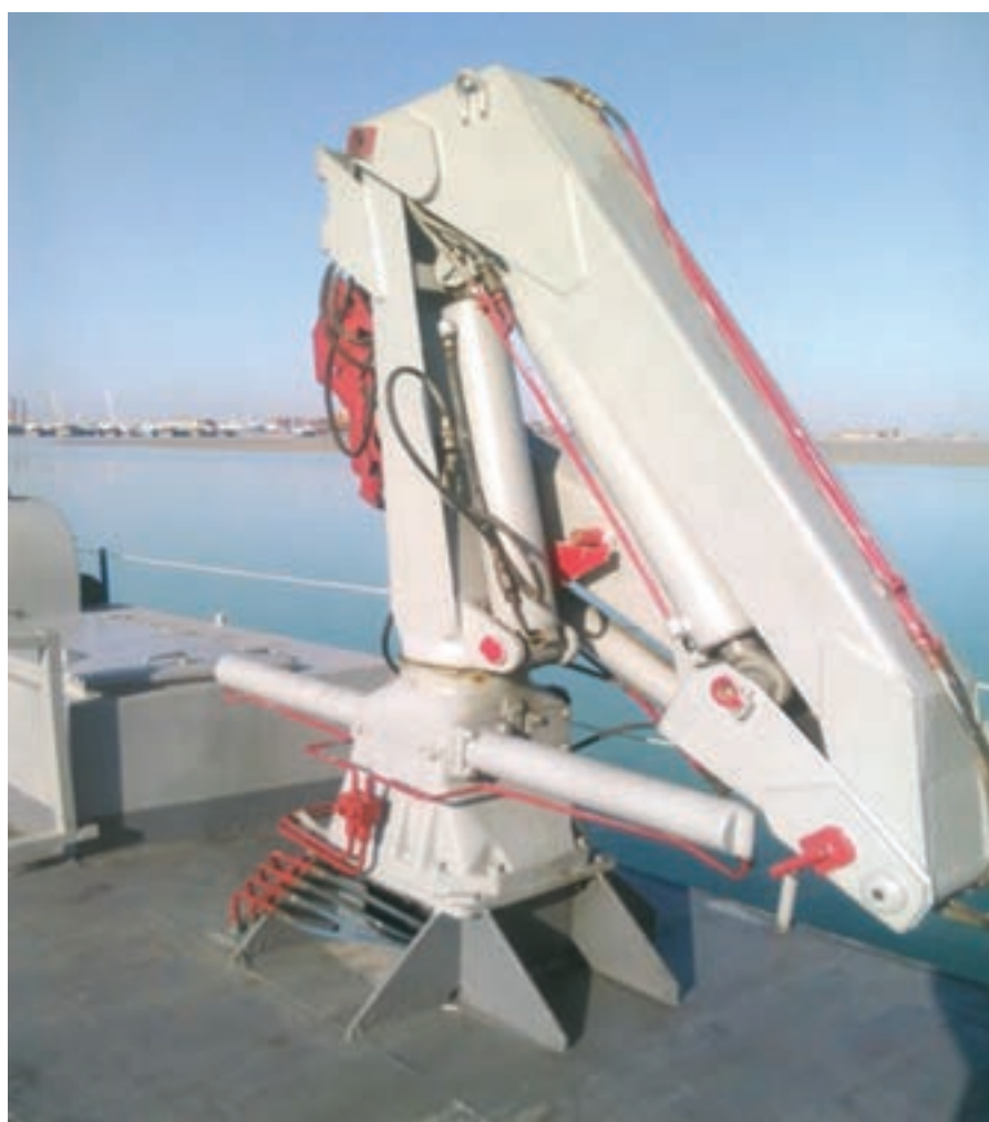
شکل ۲۲- جک هیدرولیکی بر عرشه یک شناور
