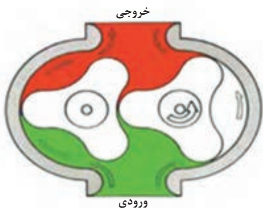
شکل ۸- ساختمان و نمای داخلی پمپ گوشواره‌ای
