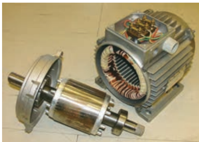
شکل ۳- اجزای تشکیل‌دهنده ماشین‌های جریان مستقیم
