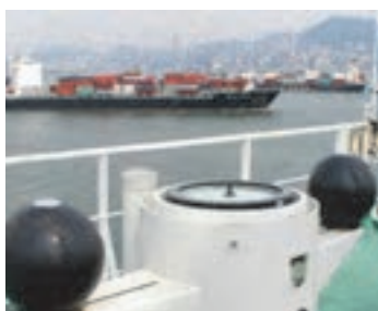
شکل ۲- پایه و گوی‌های تنظیم‌کننده قطب‌نما
