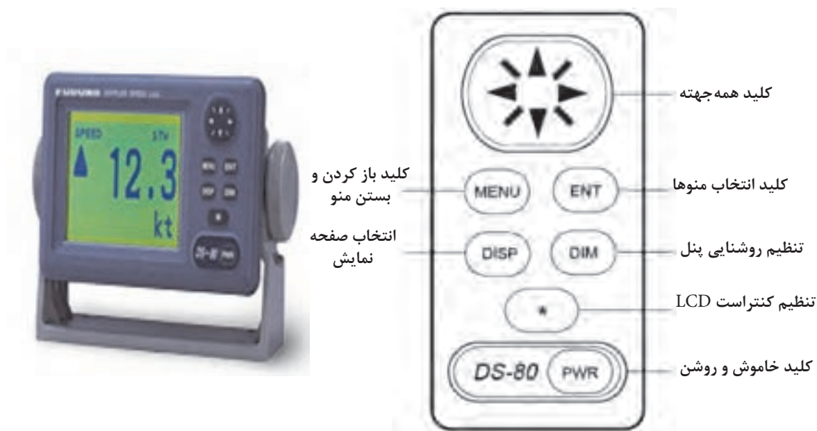
شکل ۳۱- نمای کلی کلیدهای کنترل سیستم سرعت سنج
