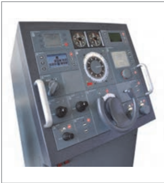
شکل ۲۶- سامانه هدایت خودکار در کشتی‌ها
