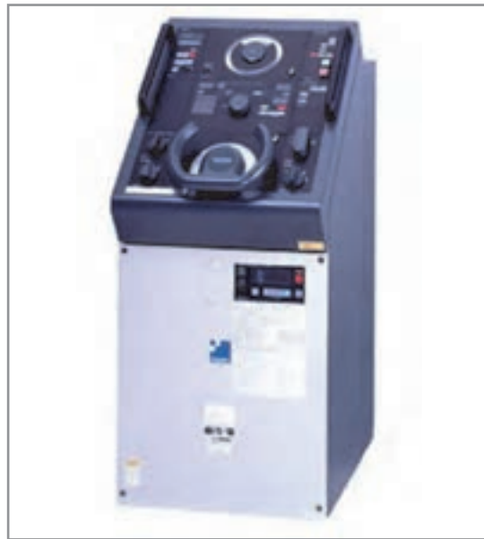
شکل ۲۶- سامانه هدایت خودکار در کشتی‌ها
