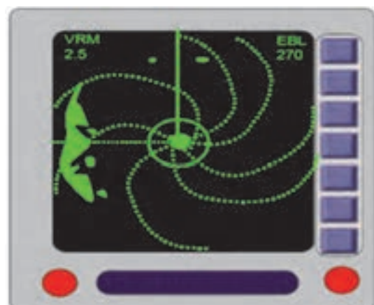
شکل ۱۸- اکوی ناشی از تداخل راداری
