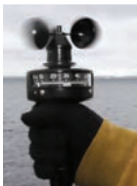
شکل ۱۵- بادسنج دستی
