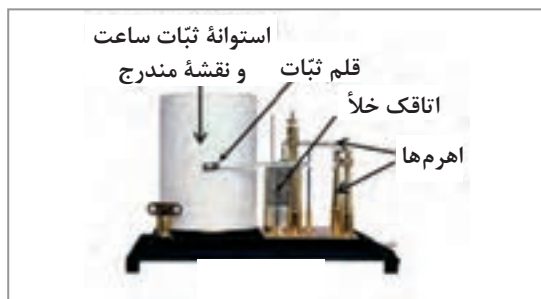
شکل ۴ - فشار نگار
