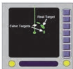
شکل ۱۶- نمایش پژواک‌های جانبی در صفحه نشانگر رادار
