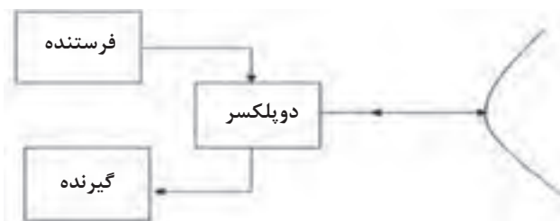
شکل ۲- بلوک دیاگرام یک رادار ابتدایی
