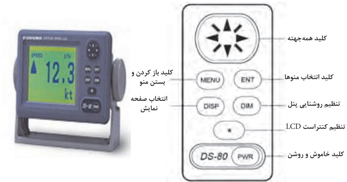
شکل ۳۱- نمای کلی کلیدهای کنترل سیستم سرعت سنج
