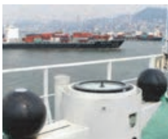
شکل ۲- پایه و گوی‌های تنظیم‌کننده قطب‌نما
