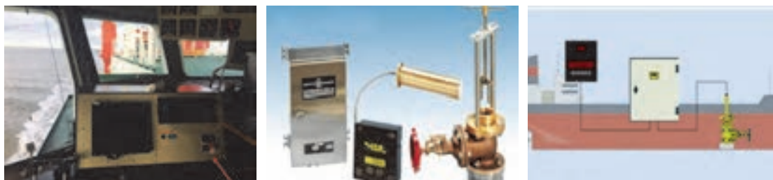
شکل ۲۶- نمایشگر و قسمت‌های تشکیل‌دهنده سرعت‌سنج الکترومغناطیسی
