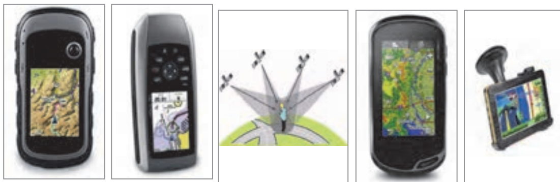
شکل ۱۱- چند نمونه از گیرنده‌های دستی G.P.S و نحوه تعیین مختصات و جهت‌یابی با آنها
