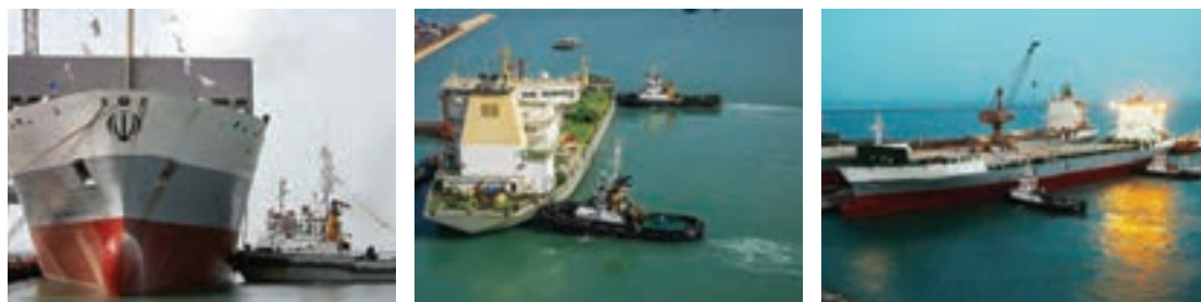
شکل ۲۹- عملیات یدک‌کشی پهلوپهلو
