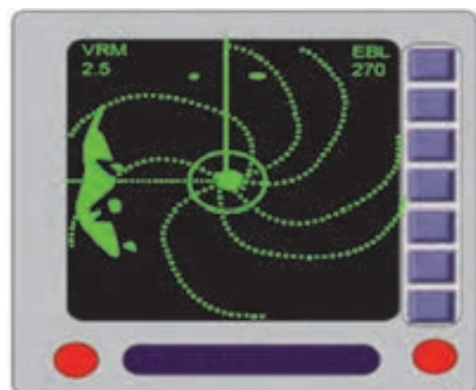
شکل ۱۸- اکوی ناشی از تداخل راداری
