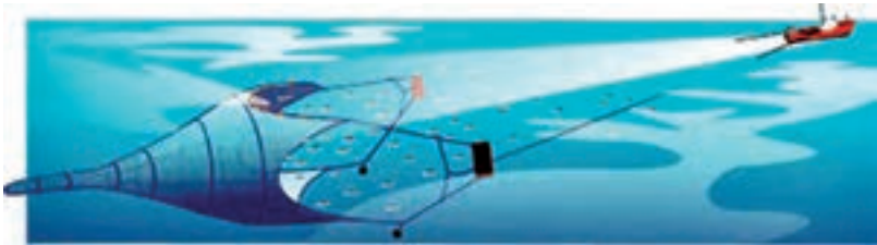
شکل ۱۹- تور ترال میان آبی و نحوه صید با آن
