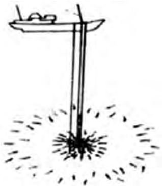
شکل ۱۸- طرح کلی از نحوه صید با کمک نور و پمپ‌های مکنده
