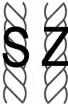
شکل ۲۳- جهت تاب در نخ‌های ماهیگیری و انواع طناب‌ها.
